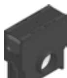
Пескоуловитель с оцинкованной корзиной для мусора и щелевой чугуной решеткой, SW 6 мм, кл. С 250
